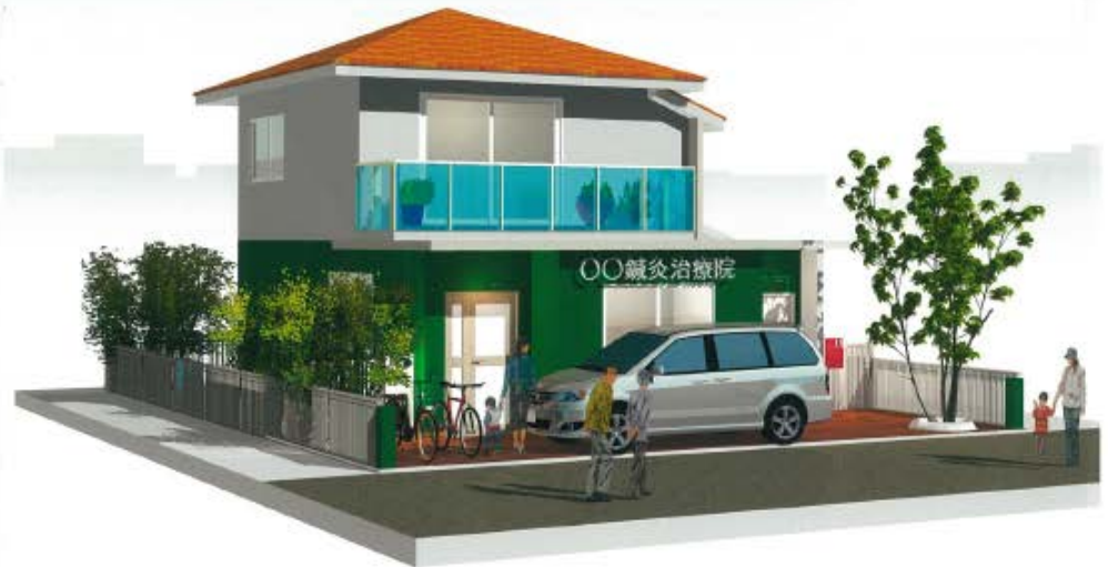
居住部と治療院とは左右に出入り口を設け、動線を分けます。内部では接続します。
